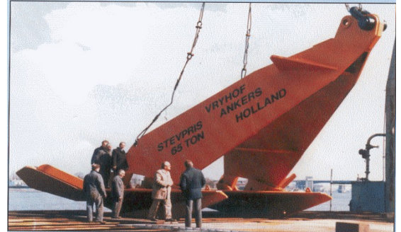
Het grootste anker ooit gemaakt, een Steypris, 65 ton
